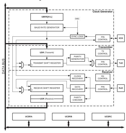
Figure 82. USART Block Diagram<sup>(1)</sup>
